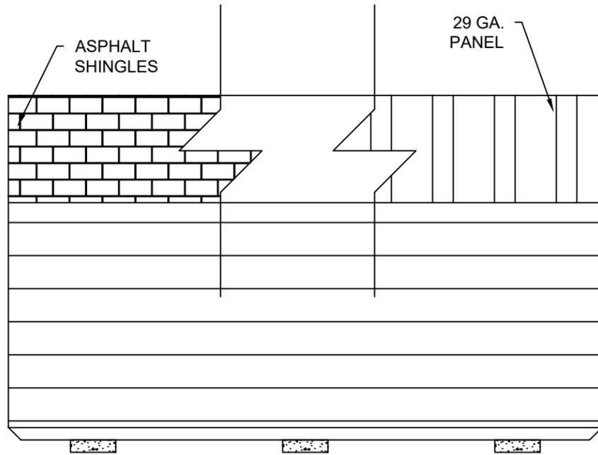
**1 SIDE WALL ELEVATION WITH LAP SIDING**
