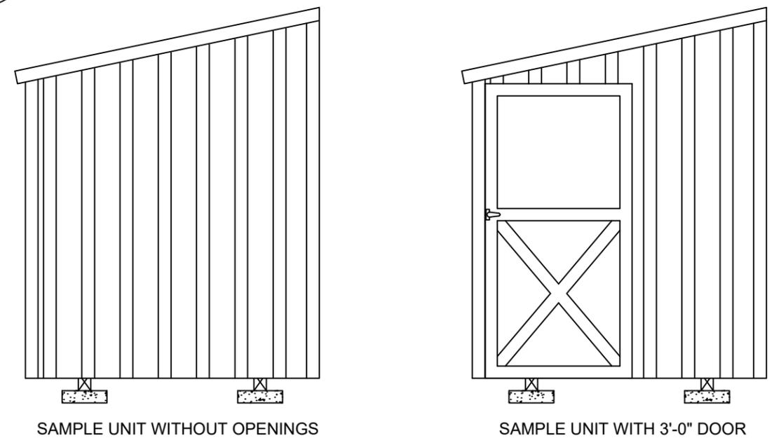
2 **ENDWALL ELEVATION WITH PANEL SIDING**
