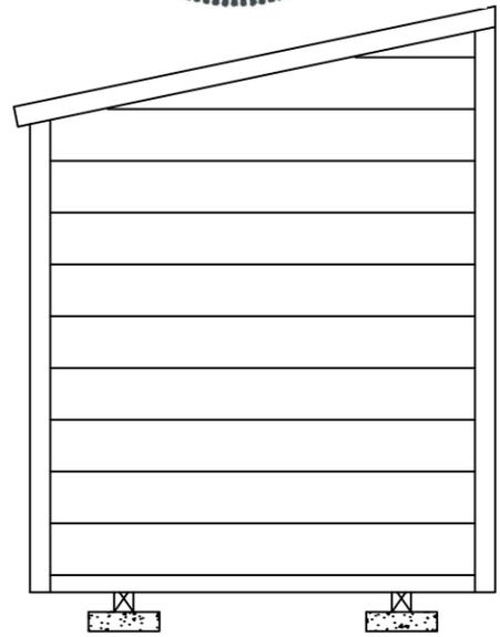
**4 ENDWALL ELEVATION WITH LAP SIDING**
