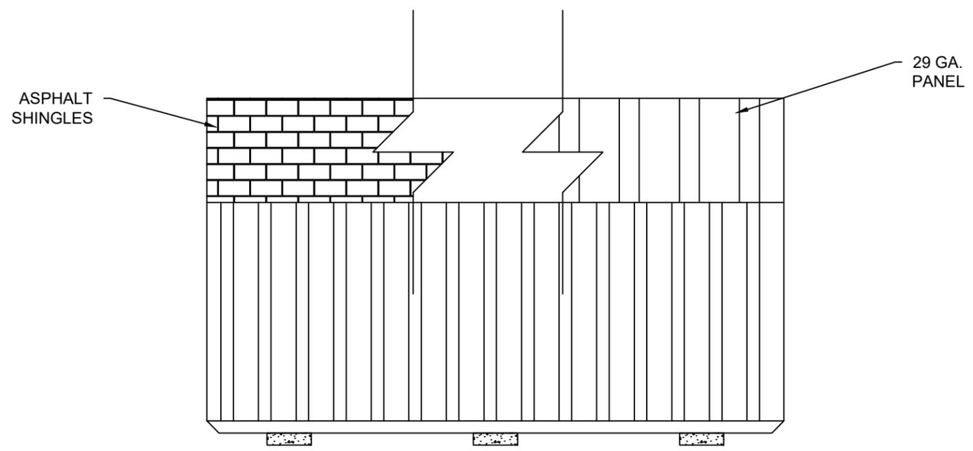
1 **SIDE WALL ELEVATION WITH PANEL SIDING**
