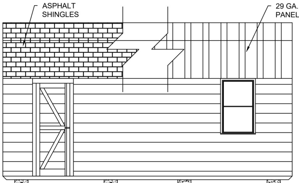
**1 SIDE WALL ELEVATION WITH LAP SIDING**
