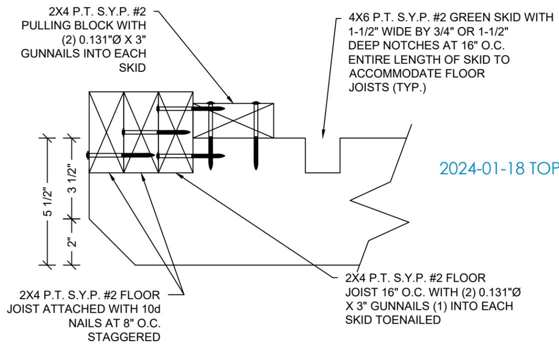
**2 END WALL JOIST DETAIL**
