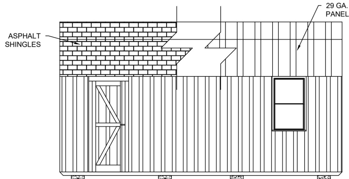
**1** **SIDE WALL ELEVATION WITH PANEL SIDING**
